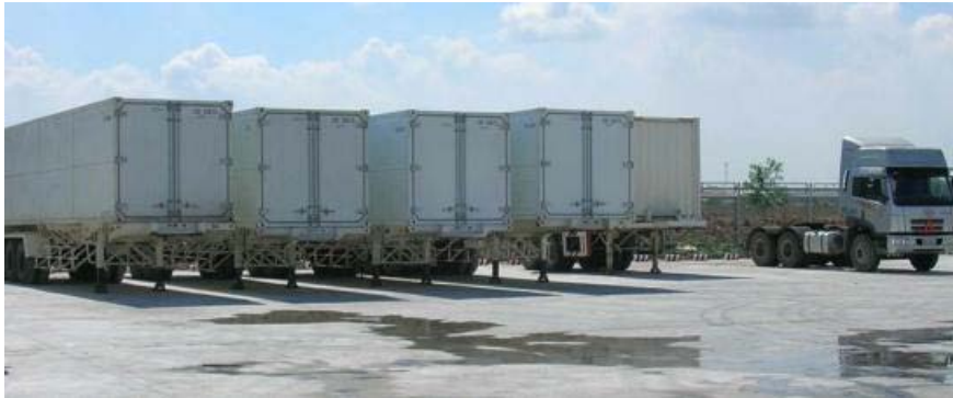
TITAN™ Modules ขณะรอการอัดก๊าซที่สถานีแม่
